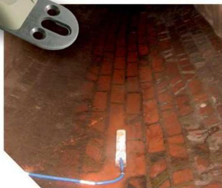
Vamzdinis jutiklis Montuojamas vamzdžiuose ir NIVUS Pipe Profiler
