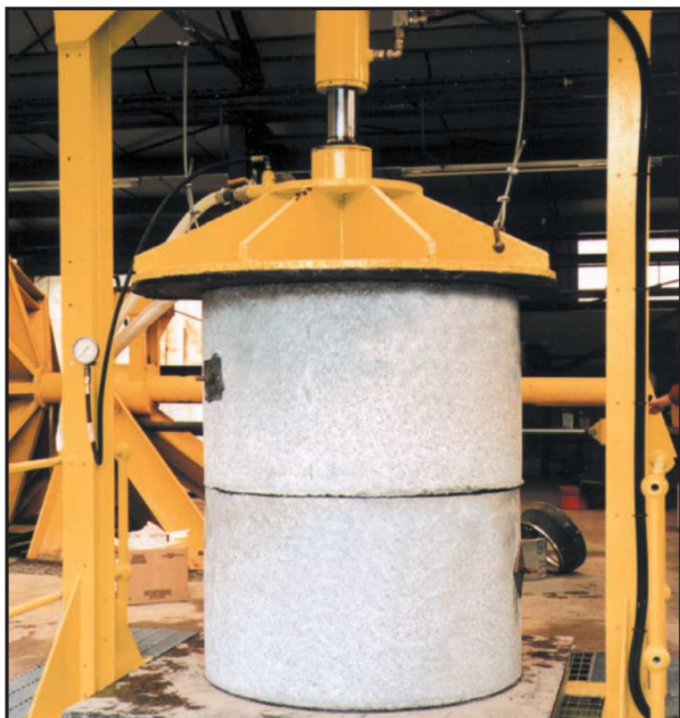
Nepriklausomos laboratorijos atliekamas slėgio vandens pratekėjimo testas.
