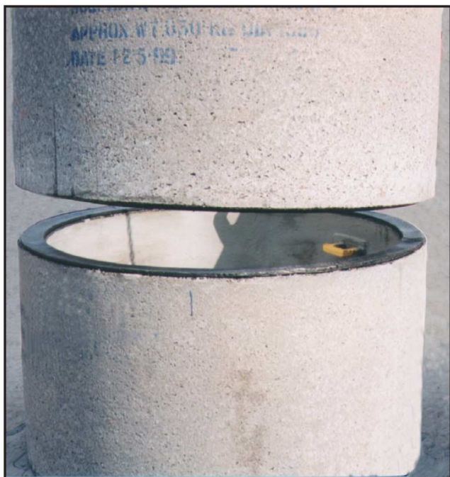
Nepriklausomos laboratorijos atliekamas slėgio vandens pratekėjimo testas.
