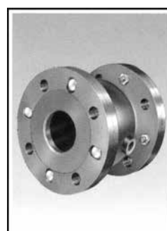
QV Uždromasis membraninis vožtuvas su tiesiu vidiniu kanalu, skirtas nuotekoms, dumbliui ir skysčiams su kietomis dalelėmis.
